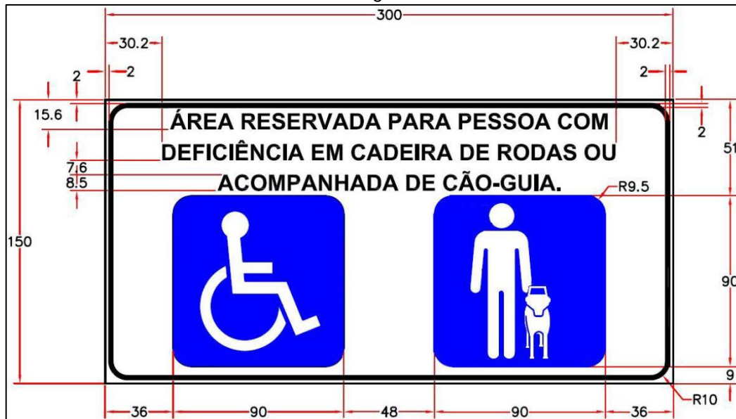
Figura 4-34 - Identificação da área reservada para pessoa em cadeira de rodas ou acompanhada de cão-guia
